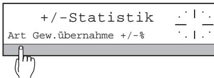
→ Unter "Art" die Art festlegen, wie die Proben auf die Waage gelegt werden.
