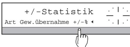
→ "+/-%" anwählen (markieren), wenn die Toleranzgrenzen für die Gewichtskontrolle und die Wägeresultate in % des Nominalgewichts eingegeben bzw. angezeigt werden sollen, oder wenn das Nominalgewicht durch Wägen eines Referenzgewichts (Funktion Set100%) gesetzt werden soll. Umschaltung zur Anzeige der Resultate in Gewichtseinheit ist immer möglich.
