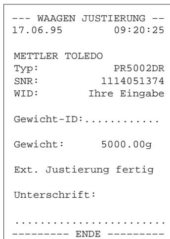
Bei angeschlossenem Drucker, z.B. LC-P43 von METTLER TOLEDO, kann die Justierung automatisch protokolliert werden, siehe Abschnitt 6.3.
