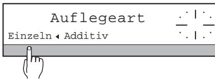
**"Einzeln"** Jede Probe wird einzeln auf die Waagschale gelegt (Werkseinstellung).
