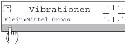
→ Die den Umgebungseinflüssen (Vibrationen, Luftzug) am Aufstellungsort entsprechende Einstellung in der unteren Zeile der Anzeige markieren.
