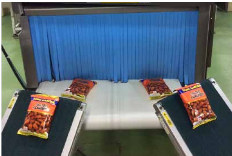
双通道 X 射线机可检测从两条包装生产线馈入的产品中的污染物
