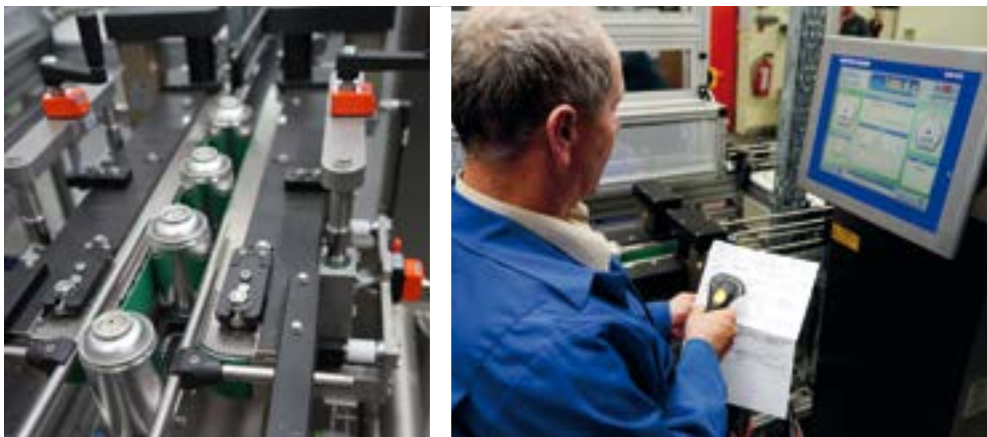
链条取代了传统的传送带，与延长手柄传输带一起，确保了平稳的产品传输（左图）。通过扫描条形码（右图）将来自数据库的产品参数加载进自动检重秤。
