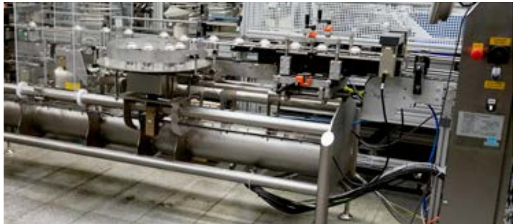
เครื่องตรวจสอบน้ำหนักระบบสายพานแบบไฮโดรสถิตเพื่อความเสถียรสูงสุดเพื่อผลลัพธ์การชั่งน้ำหนักที่ถูกต้องแม่นยำสูง
