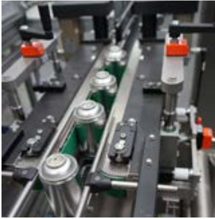
ระบบสายพานแบบโซ่ใช้แทนระบบสายพานลำเลียงดั้งเดิม พร้อมมีสายพานลำเลียงแบบยึดจับด้านข้าง เพื่อให้การขนถ่ายผลิตภัณฑ์ทำได้สิ้นไหล (ภาพซ้าย) พารามิเตอร์ผลิตภัณฑ์จากฐานข้อมูลจะถูกโหลดเข้าสู่เครื่องตรวจสอบน้ำหนักโดยอาศัยการสแกนบาร์โค้ด (ภาพขวา)
