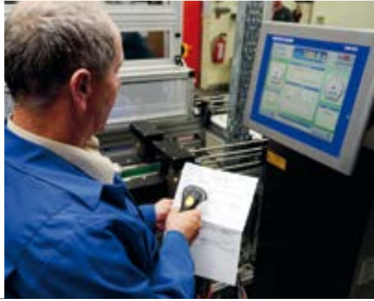
ระบบสายพานแบบโซ่ใช้แทนระบบสายพานลำเลียงดั้งเดิม พร้อมมีสายพานลำเลียงแบบยึดจับด้านข้าง เพื่อให้การขนถ่ายผลิตภัณฑ์ทำได้สิ้นไหล (ภาพซ้าย) พารามิเตอร์ผลิตภัณฑ์จากฐานข้อมูลจะถูกโหลดเข้าสู่เครื่องตรวจสอบน้ำหนักโดยอาศัยการสแกนบาร์โค้ด (ภาพขวา)
