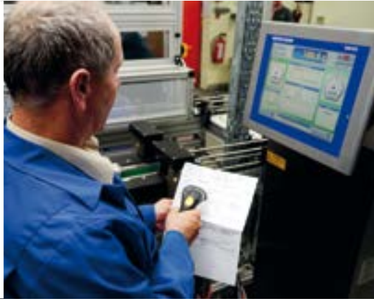
이전의 컨베이어 벨트 대신 체인을 사이드그립 컨베이어와 함께 사용하면 원활한 제품 이송을 보장합니다 (왼쪽 이미지). 바코드를 스캐닝하면 데이터베이스에서 제품 파라미터가 중량 선별기에 로딩됩니다(오른쪽 이미지).
