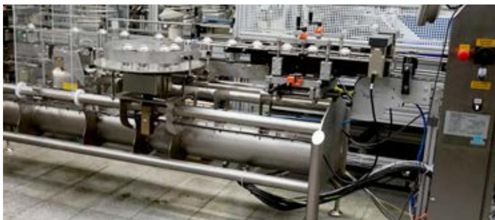
La trieuse pondérale à chaînes offre une stabilité maximale pour des résultats de pesage plus précis.
