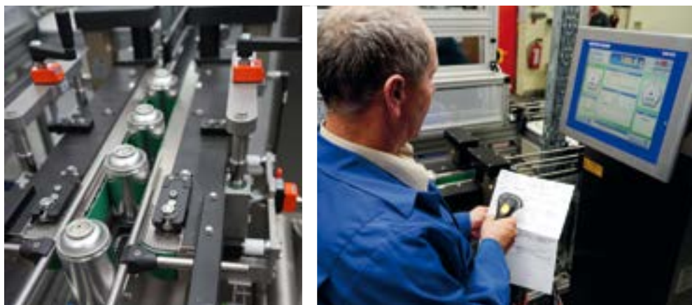
Využití řetězu s bočním vedením namísto běžného pásového dopravníku zajišťuje hladkou přepravu produktů (obrázek vlevo). Parametry produktů z databáze lze do kontrolní váhy načíst naskenováním čárového kódu (obrázek vpravo).
