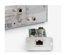
模块化硬件概念 接口 提供有各种接口选项 (插入式模块),用于连接到 Ethernet TCP/IP、PS2、蓝牙转换器 或附加的 RS232。RS232 标准接 口随时可进行服务和配置工作。
