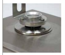
称重盘有三个孔用来固定定制 适配器以握住小瓶或管。适配器 可称重满载的 1/3 而无需限制 称重容量。无需使用工具便可将 盘从称重模块上移开。
