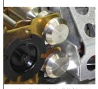
可随时使用两个集成的校准砝 码对功能性、线性和精度进行 检查。如果少于满载的 25%,则 不需要移除称重盘顶部的客户 特定适配器以进行校准。
