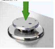
称重传感器具有垂直过载机械 保护,可承受的垂直静态过载范 围是称重容量的 25 到 50 倍。 在处理设备出现故障或安装期 间出错时,它可保护称重模块。
