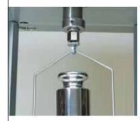
可选适配器允许在称重模块下 面称重悬挂的负荷。 所有方向上 的过载保护仍有保证。
