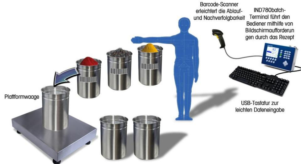
Abbildung 15-12: Diagramm des IND780batch-Systems für manuelle Rezepturen
