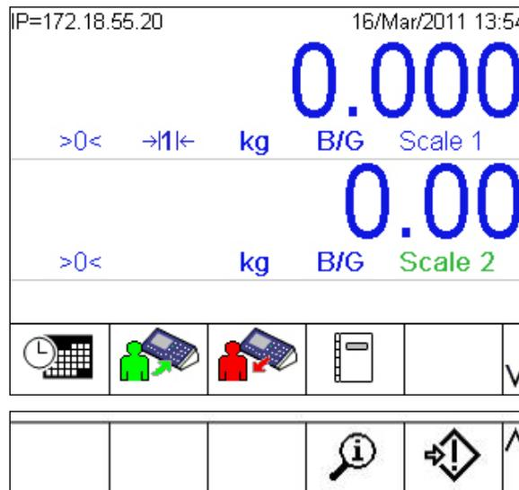
Abbildung 2-7: Waagenansichtsbildschirm (oben) und zweite Zeile der Softkeys (unten)
