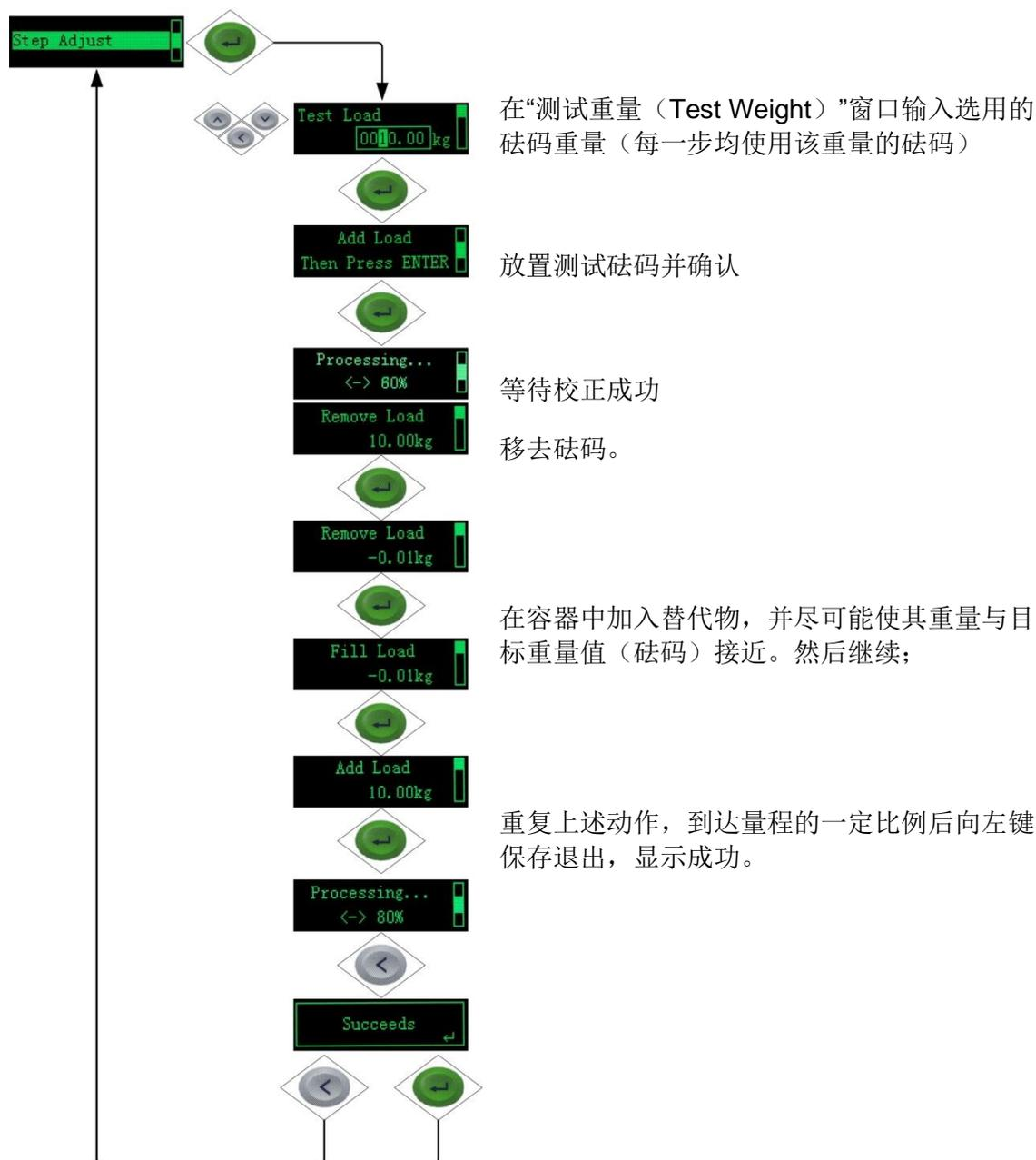
图 4-42: 逐步替代法校正
