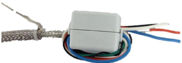
图 2-13: 信号电缆线穿过磁环
