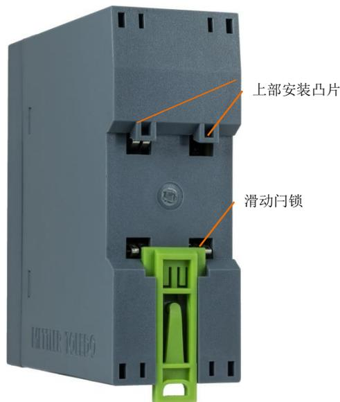
要将 ACT350 安装到导轨上，下拉闩锁以打开它，然后放置变送器以便上部凸片靠在 DIN 导轨上。然后使用螺丝刀闭合闩锁，将变送器固定到位。
