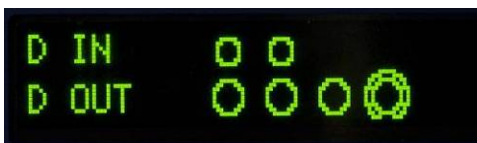
Figura 3-19: Display de teste de E/S discreta, uma saída ativa (base)
