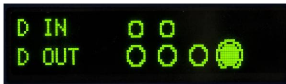
Figura 4-6: Tela de teste de E/S discreta, uma saída ativa
