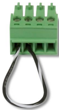
Figura 4-4: Jumper entre a os terminais de transmissão e recepção COM
