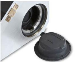
Entfernen Sie die Abdeckung, indem Sie sie aus dem Terminal ziehen. Beachten Sie die Laschen auf der Akkuabdeckung.
