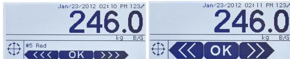
**Abbildung 4-7: Zusammengesetzte grafische SmartTrac-Anzeige: Klein (links) und groß (rechts)**
