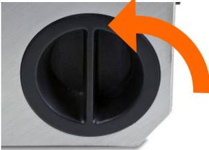
Die runde Akkuabdeckung befindet sich auf der rechten Seite des Terminals. Drehen Sie die Abdeckung um eine Viertel Umdrehung gegen den Uhrzeigersinn, bis der Griff senkrecht steht.
