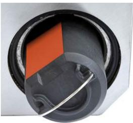
Führen Sie ein vollständig aufgeladenen Akkupack so in den Akkuohorraum ein, dass der Drahtgriff in Richtung Außenseite des Terminals weist. Richten Sie die flache Seite des Akkus mit der flachen Seite des Hohlrums aus (siehe Abbildung links).
