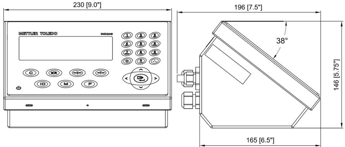
**Abbildung 1-2: IND246-Gehäuseabmessungen**
