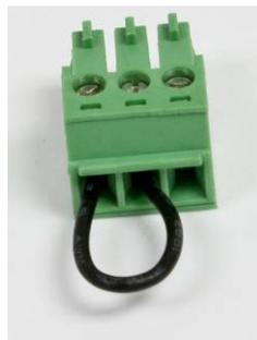
**Abbildung 5-6: Drahtbrücke zwischen COM1-Sende- und Empfangsklemmen**
