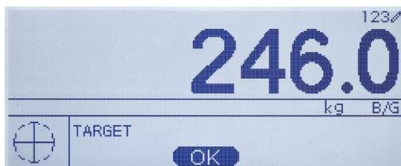
Abbildung 2-12: Bildschirm der Kontrollwäganwendung
