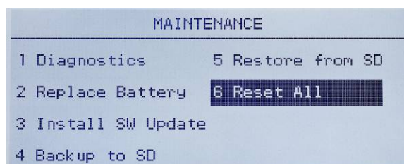
Figure 3-32 : Réinitialisation de tous les blocs de configuration
