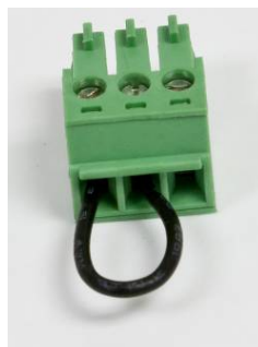
Figure 5-6 : Cavalier entre les bornes de transmission et de réception de COM1
