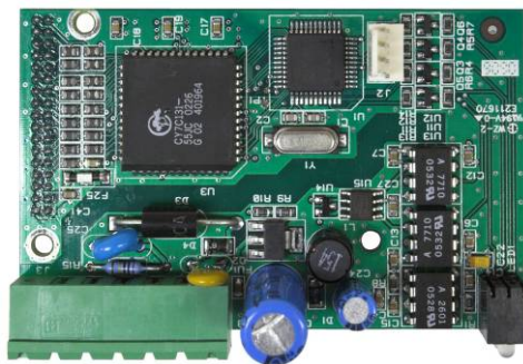
Figura 2-63: scheda opzionale DeviceNet
