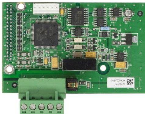
Figura 2-53: scheda opzionale uscita analogica
