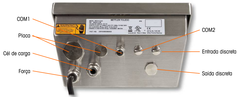
Figura 2-25: Atribuições de prensa-cabos de gabinete para ambiente adverso
