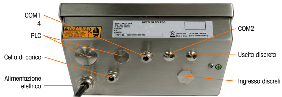
Figura 2-25: Assegnazioni dei pressacavi dell'armadietto per ambienti difficili
