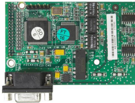
Figura 2-67: scheda opzionale PROFIBUS, armadietto con montaggio a pannello
