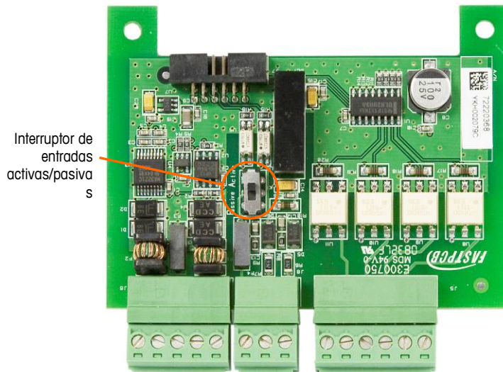
Figura 2-50: Tarjeta opcional COM2/E/S discontinuas (estado sólido)
