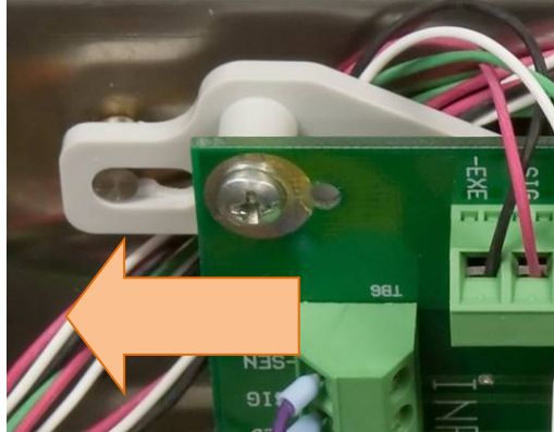
Figura 2-34: Remover a placa de soma
