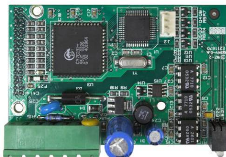
Figura 2-63: Tarjeta opcional DeviceNet
