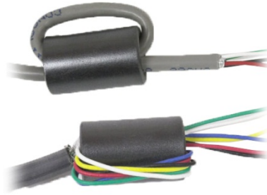
Figure 2-24 : Installation du tore de ferrite
