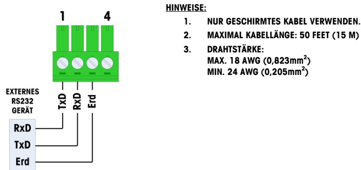
Abbildung 2-41: Beispiel für RS23A-Anschlüsse
