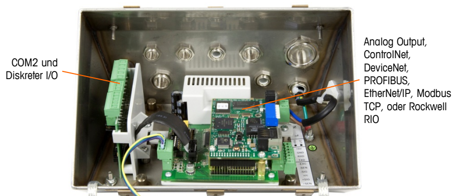
Abbildung 2-43: Optionspositionen im Gehäuse für raue Umgebungen
