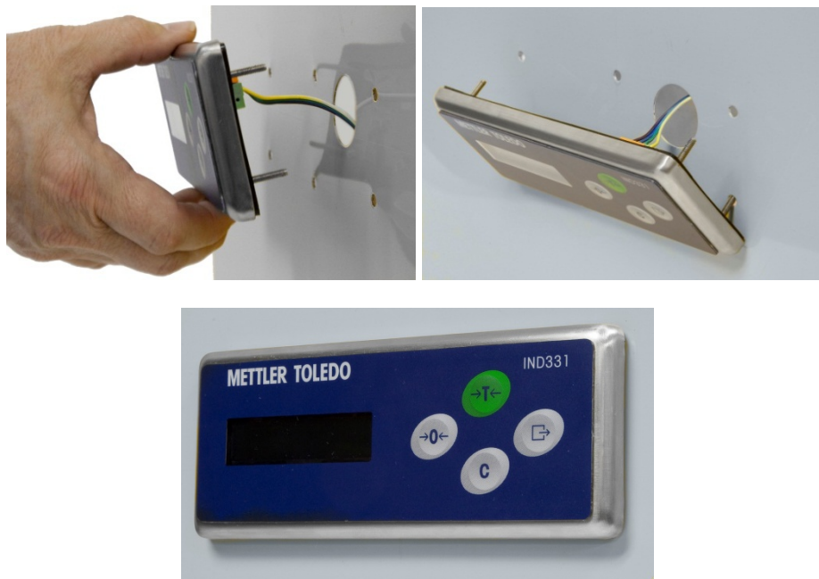
Figure 2-11 : Montage de l'interface opérateur
