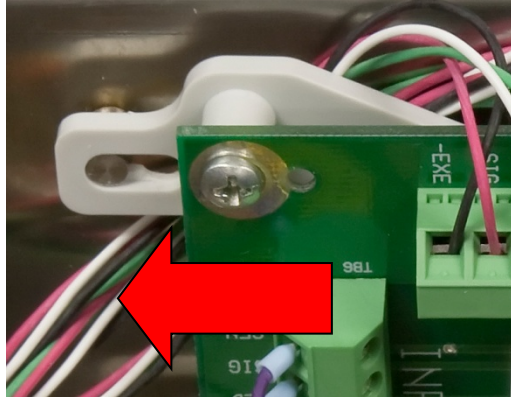
Figura 2-34: Rimozione della scheda di somma
