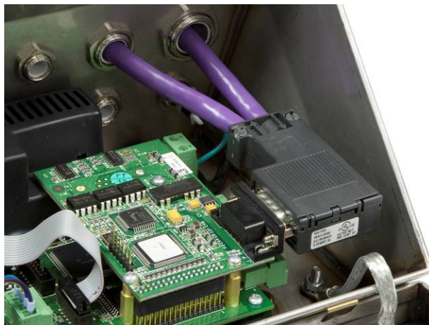
Figura 2-69: Roteamento do cabo PROFIBUS para gabinete adverso
