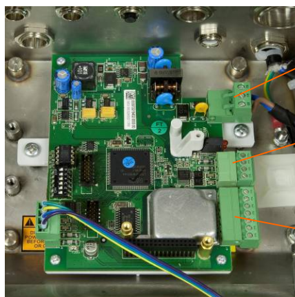
Figura 2-31: connessioni armadietto per ambienti difficili
