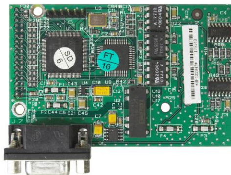
Figura 2-67: Tarjeta opcional PROFIBUS, gabinete para montaje en panel
