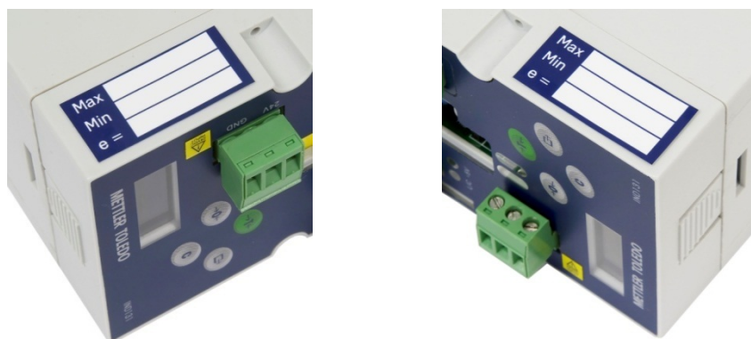
Figure 2-79 : Emplacements pour l'étiquette de capacité, unité DIN
