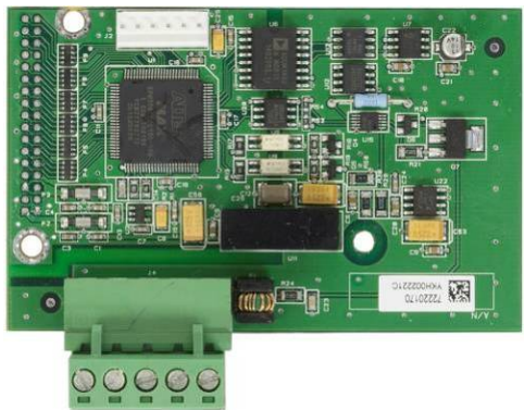
Figura 2-53: Tarjeta opcional de salida analógica
