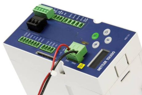
Figura 2-32: Connessione alimentazione CC
