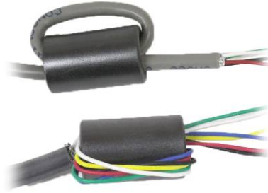
Figura 2-24: Instalação do núcleo de ferrite
