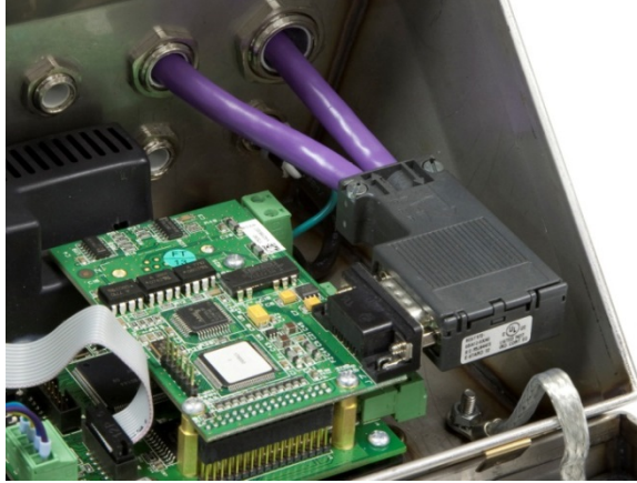
Figura 2-69: Colocación del cable PROFIBUS en el gabinete para ambientes adversos
