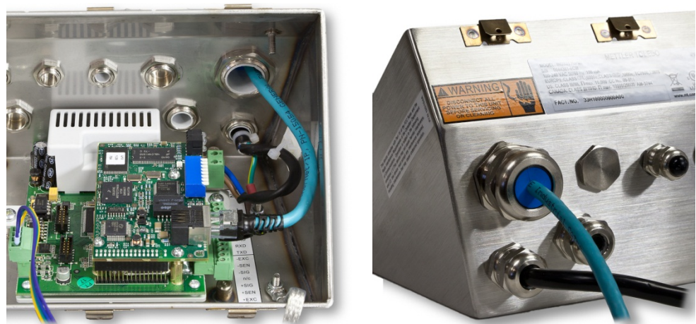
Abbildung 2-66: Ethernet-Kabelführung für das Gehäuse für raue Umgebungen
