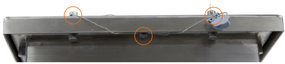
Abbildung 2-85: Versiegeln der Aktualisierte Abzweigkastenversion – Versiegelungsstifte und -schrauben
