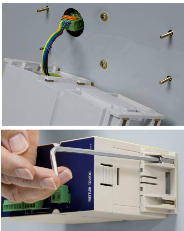
Figura 2-14: installazione del modulo DIN
