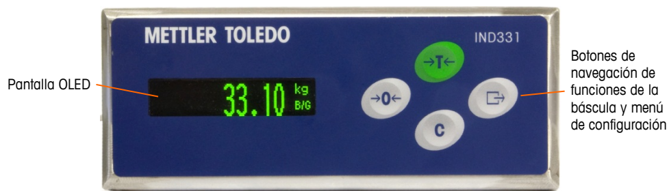
Figura 1-9: Distribución del panel frontal de la IND331
