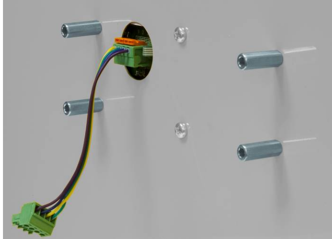
Figura 2-15: Parte posterior do display com longas porcas instaladas.
