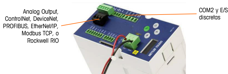
Figura 2-42: Ubicación de las opciones en los módulos de montaje en DIN, panel y en caja de conexiones
