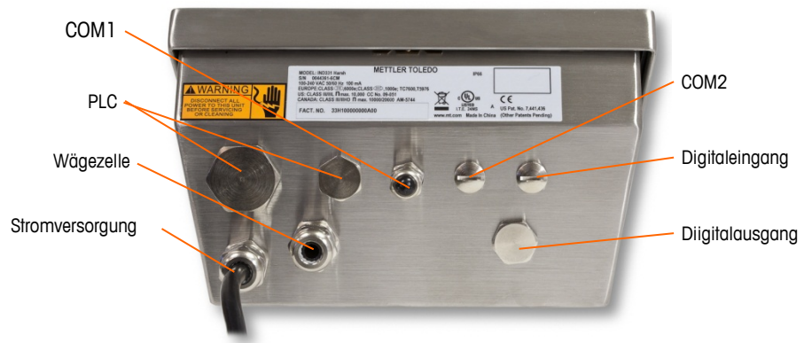
Abbildung 2-25: Kabelstutzenzuweisungen des Gehäuses für raue Umgebungen
