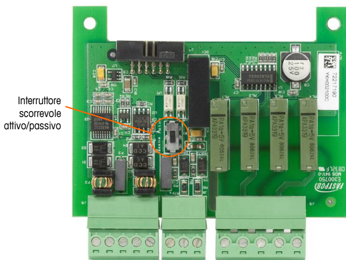
Figura 2-45: scheda opzionale COM2/I/O discreto (relè)
