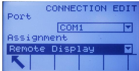
**Abbildung 3-11: COM1-Verbindung für den Remote-Betrieb konfiguriert**
