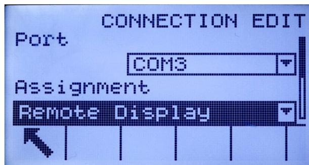
**Abbildung 3-13: COM2/COM3-Verbindung für Remote-Betrieb konfiguriert**
