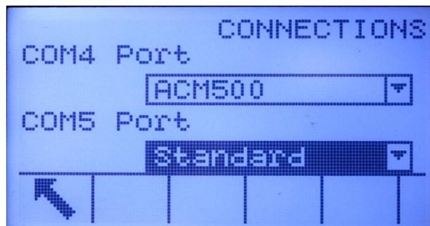
**Abbildung 3-12: COM4-Verbindung für ACM500 konfiguriert**
