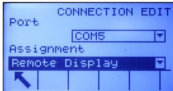
Abbildung 3-15: COM4- oder COM5-Verbindung für Remote-Betrieb konfiguriert
