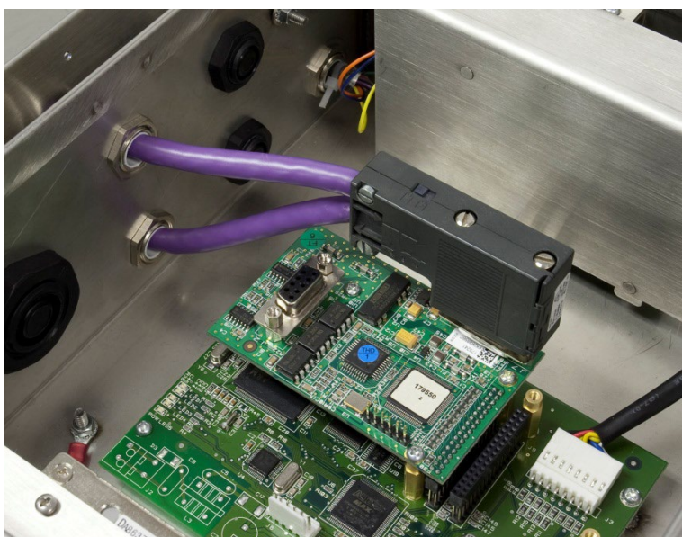
Figure 3-23 : Connexion PROFIBUS dans l'ACM500
