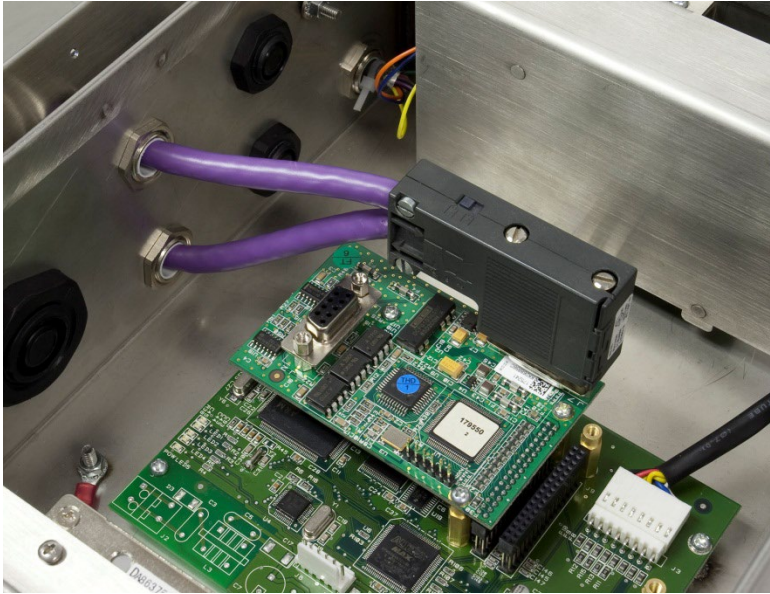
Figura 3-23: Conexión de PROFIBUS en el ACM500
