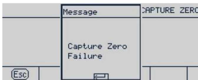
Figure 3-13 : Étalonnage du zéro (échec)
