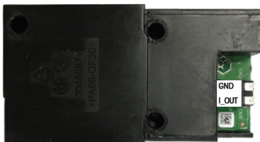
Figura 2-12: Tarjeta opcional de salida analógica intrínsecamente segura
