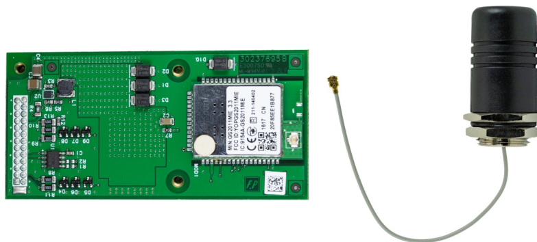
Figura 2-14: Tarjeta opcional WiFi del IND256x y antena
