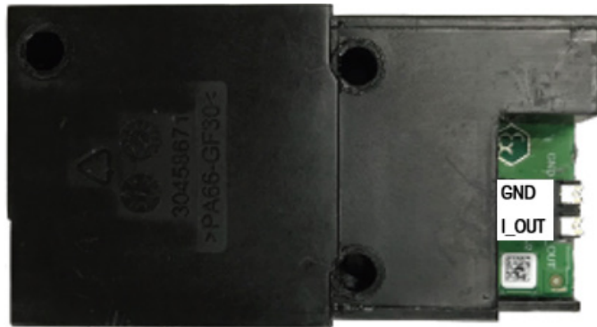
Abbildung 2-12: Eigensichere Optionsplatine für analogen Ausgang
