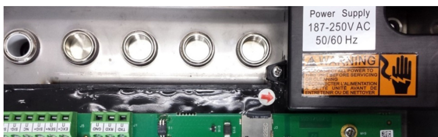
Figura 2-3: Connettore di ingresso alimentazione CA con coperchio
