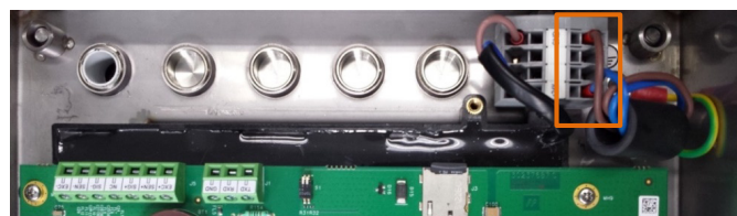
Figura 2-6: Conexiones de entrada de energía de CD, vista interna
