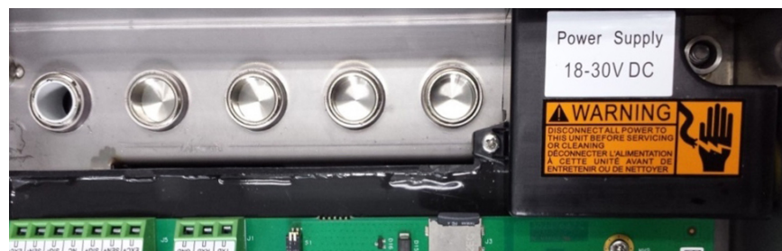
Figure 2-5 : Connecteur d'entrée d'alimentation CC avec bouchon de protection
