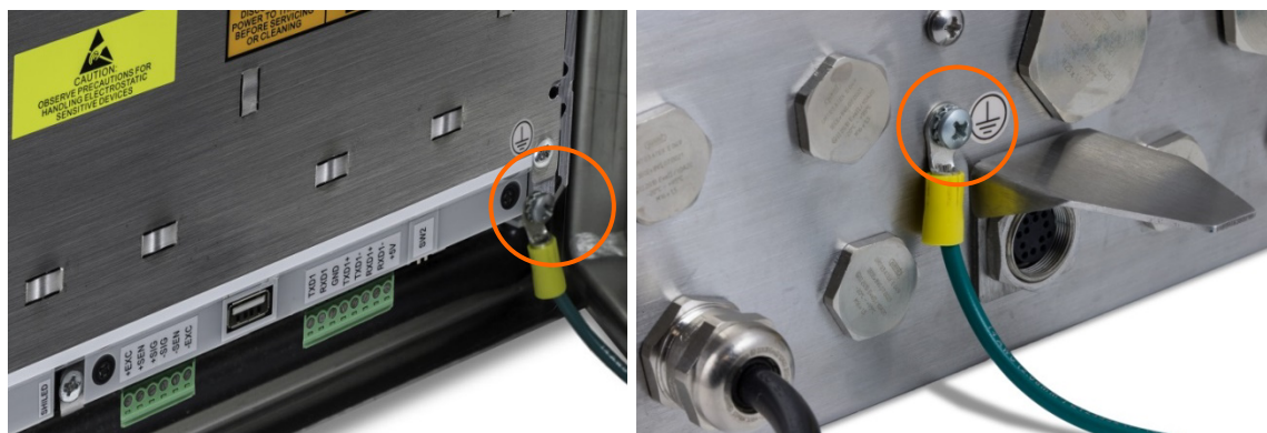
Figure 2-5: Points de mise à la terre du terminal IND570xx avec montage sur panneau (à gauche) et pour environnement rude (à droite)
