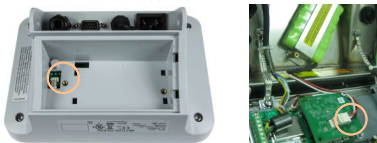
IND231(左)和 IND236（右）可充电电池组连接器
