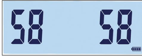
Figura 4-5: Tela de Teste da Serial – Dados Transmitidos (à esquerda) e Recebidos (à direita)
