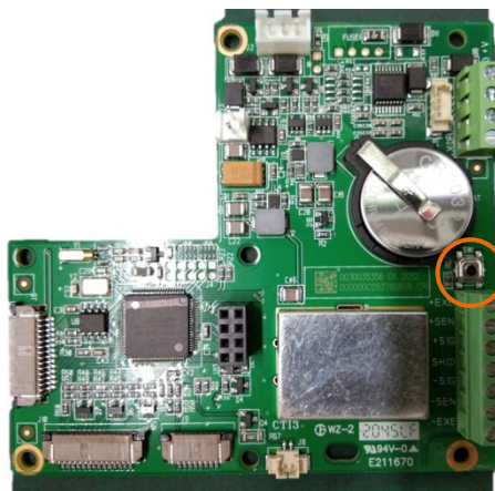
Figura 3-2: Localização de Chave de Configuração na Placa Principal do Terminal
