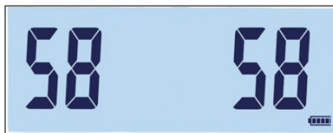
Figura 4-5: Tela de Teste da Serial – Dados Transmitidos (à esquerda) e Recebidos (à direita)
