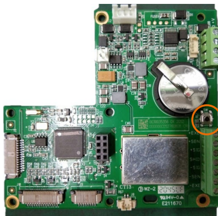
Abbildung 3-2: Lage des Setup-Schalters auf der Hauptplatine des Terminals
