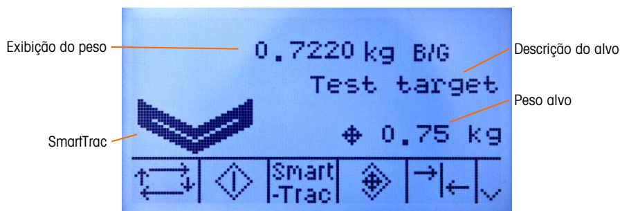
Figura 2-19: Exibição de excesso/falta, médio
