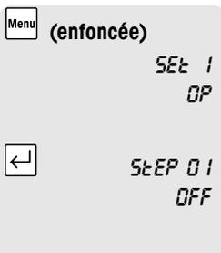
1. Appuyer sur la touche **Menu** et la maintenir enfoncée jusqu'à ce qu'une longue tonalité se fasse entendre. SET 1 OP est affiché pour "Operator Setup"
