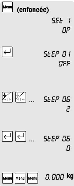
1. Appuyer sur la touche **Menu** et la maintenir enfoncée jusqu'à ce qu'une longue tonalité se fasse entendre. SET 1 OP est affiché pour "Operator Setup".
