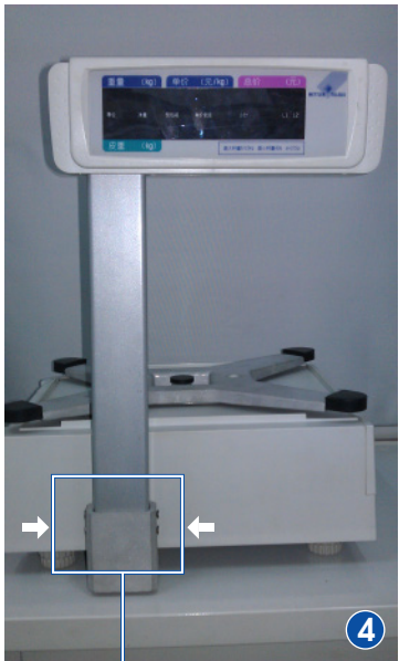
固定立杆两侧4颗螺栓
