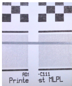
打印断码，需更换热敏打印头
