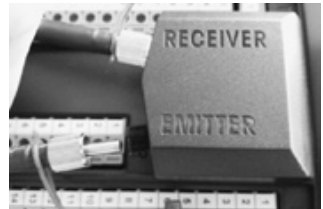
Abb. 4: SMA-Verbindung zum «Receiver/Emitter» des Transmitters M800.
