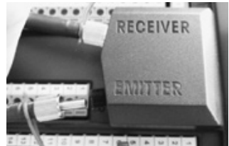
Fig. 4 : connexion du SMA au transmetteur M800 « Récepteur/Émetteur ».
