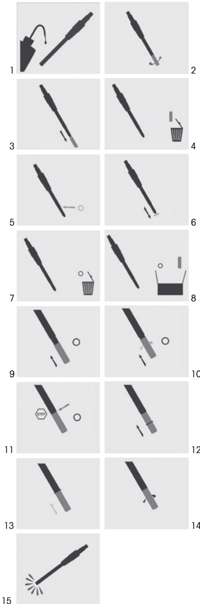
Draai de versleten OptoCap los en verwijder die samen met de oude O-ring. Vervang beide door een nieuw exemplaar. Na deze procedure moet de sensor worden gekalibreerd met een lucht- en nulpuntkalibratie met de correcte instellingen voor luchtvochtigheid en omgevingsdruk.
