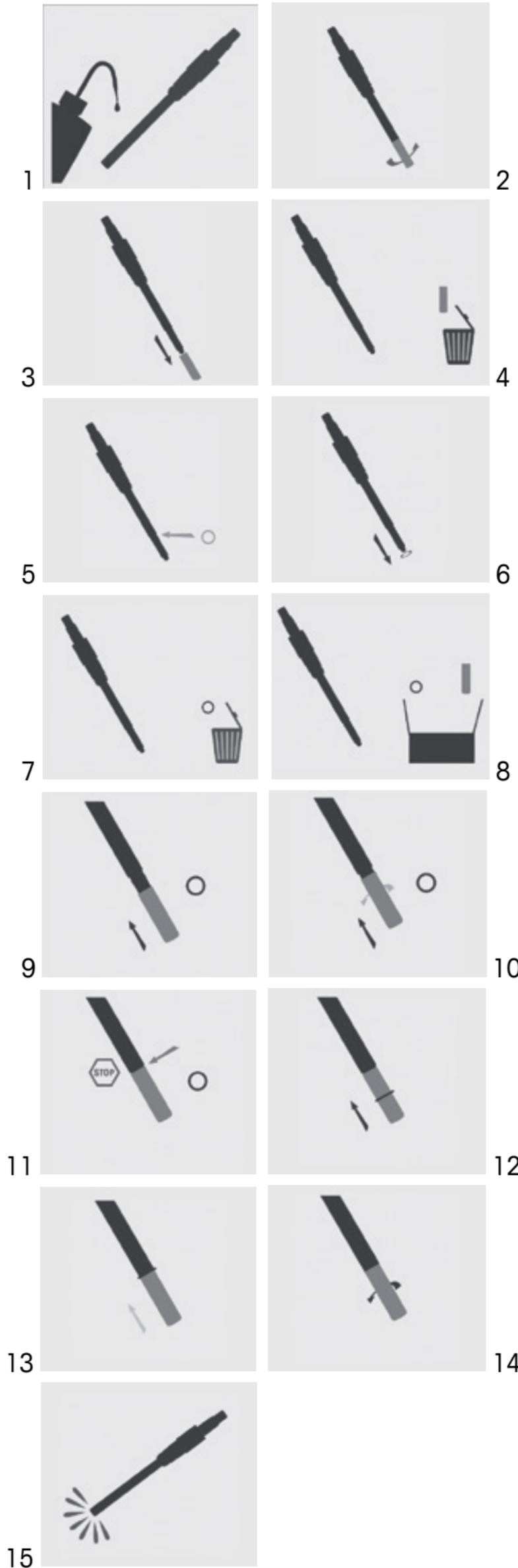
使用したオプトキヤップと古いOリングのネジを緩め、新しいものと交換します。この手順の後には、正しい湿度と環境圧力の設定を使用して、センサの空気とゼロポイント校正をする必要があります。
