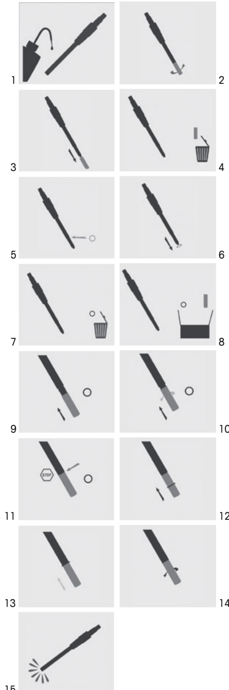
사용된 OptoCap 및 기존의 O링 나사를 풀고 제거하여 새로운 제품으로 교체하십시오. 이 절차 이후 올바른 습도 및 주변 압력을 설정을 사용해 센서에 대해 공기 및 영점 교정을 해야 합니다.
