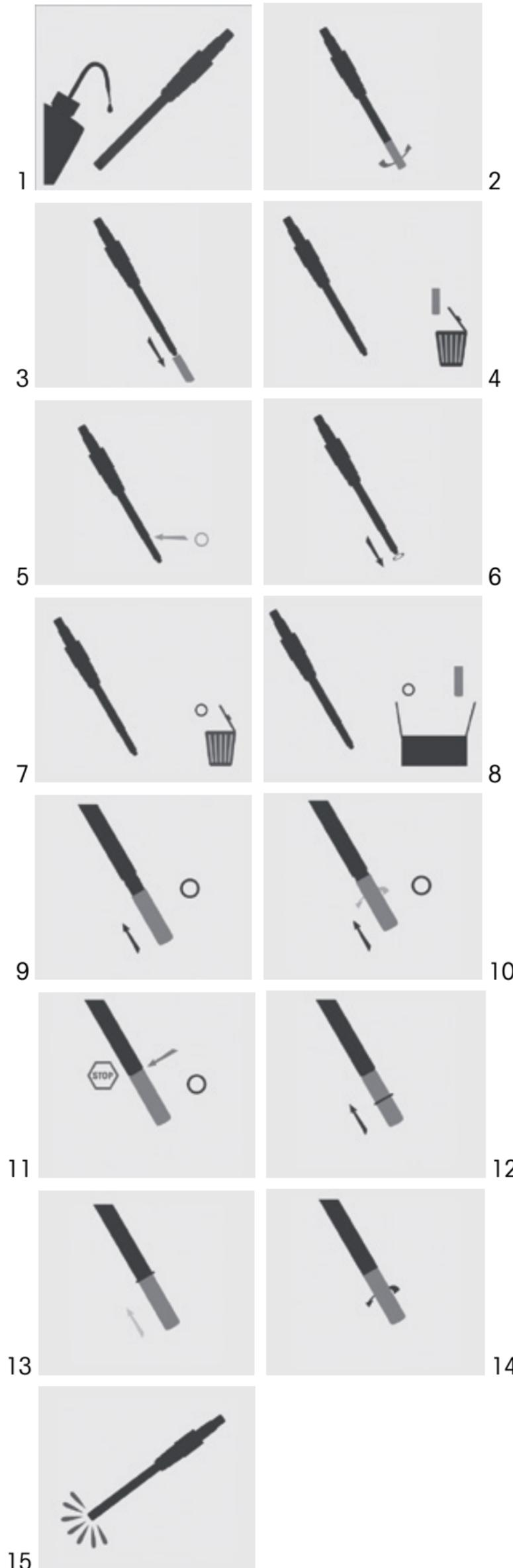
Отвинтите и снимите изношенный элемент OptoCap и кольцевое уплотнение, установите новый элемент с новым уплотнением. После этого датчик необходимо откалибровать по воздуху и по нулевой точке, следя за правильностью настроек, относящихся к давлению и влажности воздуха.
