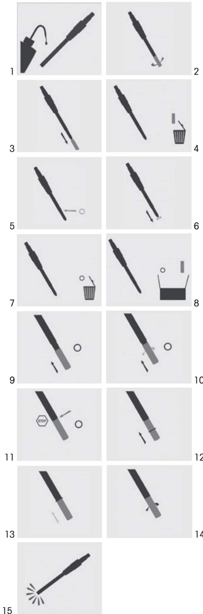
Skruga av och ta bort det uttjänta OptoCap-elementet och den gamla O-ringen och byt ut dem mot nya komponenter. När detta har utförts ska givaren kalibreras med nollpunkts- och luftkalibrering, med korrekta inställningar för fuktighet och omgivningstryck.
