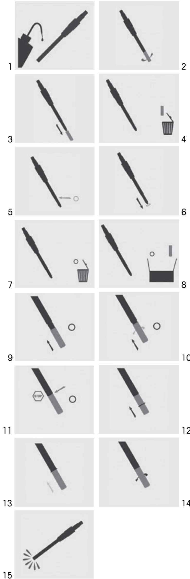
拧松并拆下使用过的 OptoCap 与旧 O 形圈，然后换新。进行此操作之后，需要使用正确的湿度与环境压力设置，通过空气与零点校准方式对传感器进行校准。
