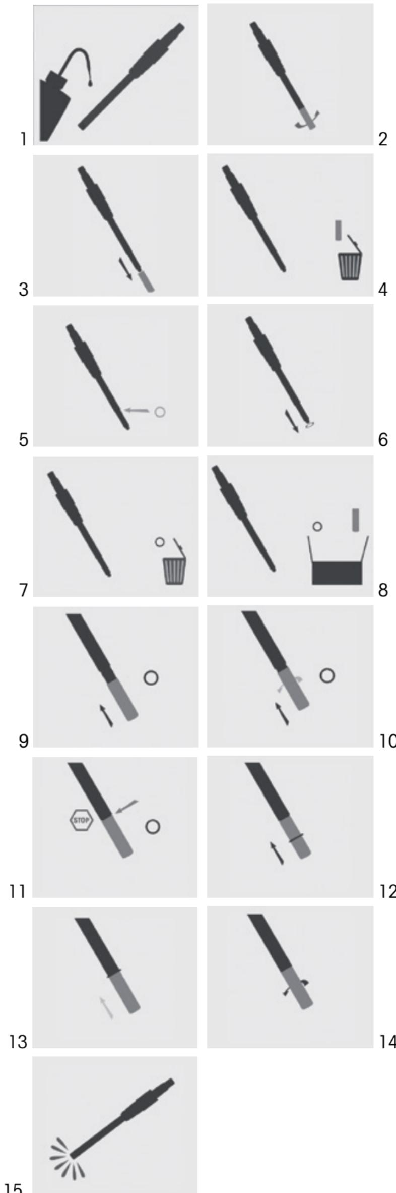
Desaperte e remova o OptoCap gasto e o antigo anel O-ring e substitua-os por novos. Depois desse procedimento o sensor precisa ser calibrado com uma calibração a ar e de ponto zero, usando-se as configurações de umidade e pressão ambiente corretas.
