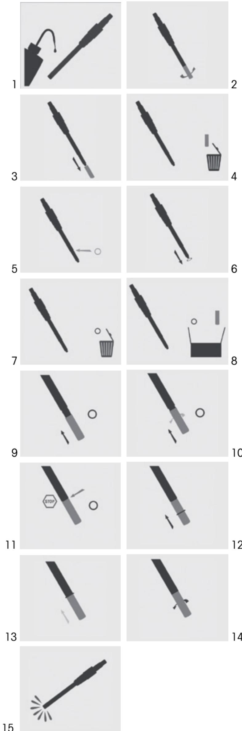
Dévissez et retirez l'OptoCap usagé et l'ancien joint torique et remplacez-les par des pièces neuves. Il convient ensuite de réétalonner la sonde avec un étalonnage de l'air et du point zéro, en indiquant les réglages d'humidité et de pression ambiante qui conviennent.
