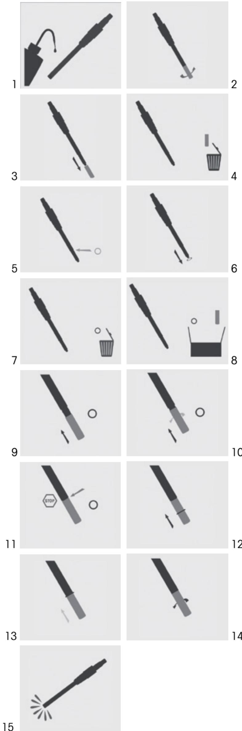
Schrauben Sie die gebrauchte OptoCap sowie den gebrauchten O-Ring ab und ersetzen Sie diese beiden Teile durch neue. Anschließend muss der Sensor mittels einer Luft- und Nullpunktikalibrierung unter geeigneten Feuchtigkeits- und Umgebungsdruckbedingungen neu justiert werden.
