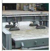
METTLER TOLEDO est le seul fabricant à effectuer des tests de cycle de vie sur des modules de pont-bascule réels. Le banc d'essai Module Masher simule 20 ans de circulation avec des camions à pleine charge. Cette procédure de test vérifie la capacité de votre pont-bascule à répondre aux besoins réels en matière de pesage.
