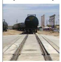
Épargnez et gagnez de la place en utilisant un pont-bascule combiné pour camions et wagons. Un même pont-bascule associe un pont-bascule statique pour wagons et une plateforme de pesage de camions. Les rails sont encastrés de manière à former une surface plane sur laquelle les camions circulent facilement et en toute sécurité.
