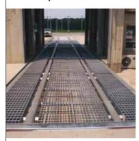
Une surface de roulement incluant un treillis d'acier permet aux camions de décharger les grains tout en étant sur la bascule.
