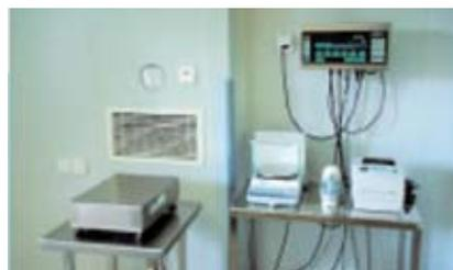
Foto 2. Cabina de pesada. Contiene el terminal para guiar al usuario, un lector de código de barras, una etiquetadora y dos balanzas de precisión
