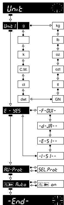
Il registro configurazioni con NetEasy-M si differenzia dal registro configurazioni della bilancia con la normale cassetta di programma soltanto nel settore –Unit–. Con la cassetta NetEasy-M nel settore –Unit– è possibile selezionare le seguenti opzioni:
