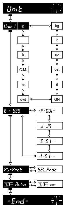
Par rapport au registre de configuration de la balance avec cassette de programme standard, le registre de configuration avec NetEasy-M change uniquement au niveau du secteur –Unit–. Dans ce cas, celui-ci propose les options suivantes:
