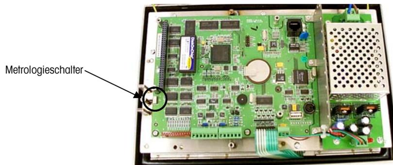
**Abb. 2-1:** Position des Metrologieschalters
