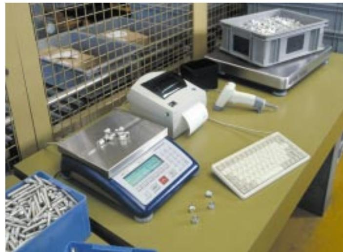
Sistema de dos balanzas: Viper SC como balanza de referencia y plataforma de pesaje analógica como multibalanza
