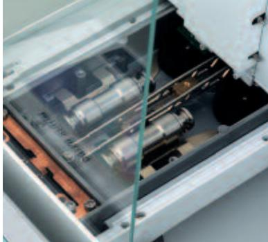
Las pesas de calibración no se pueden ensuciar ni dañar. Están totalmente protegidas debajo del plato colector.
