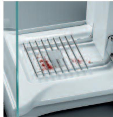
Si al dosificar se derrama sustancia junto al recipiente, esto ya no falseará el resultado de la pesada. Gracias al plato de pesada reticular, la sustancia simplemente cae en el plato situado debajo.
