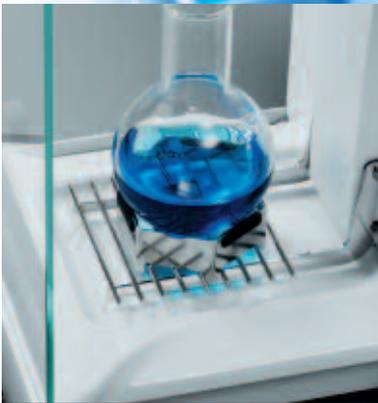
Para pesadas secuenciales rutinarias utilice solamente el plato de pesada con reducida resistencia al aire y tiempos de estabilización cortos.
