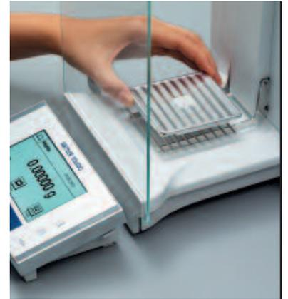
Si desea una superficie de apoyo continua, coloque el plato de acero cromado sobre el SmartGrid. Si trabaja con sustancias tóxicas, utilice el plato de aluminio desechable y tírelo después de la pesada.
