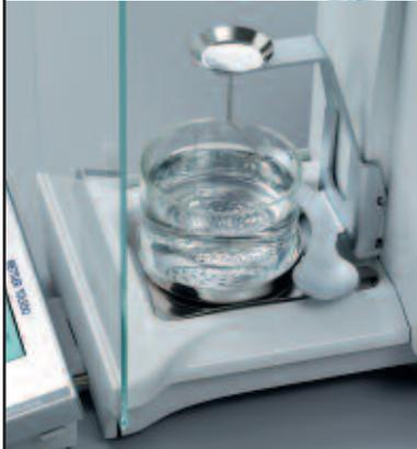
La bilancia analitica con l'accessorio per la densità: pronta per la determinazione della densità.
