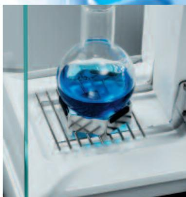
Per le operazioni di pesata ripetute durante il lavoro di routine, basta utilizzare il piatto con struttura a griglia, che offre poca resistenza all'aria e diminuisce il tempo di stabilizzazione.
