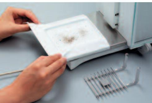
La piastra di copertura sotto il piatto della bilancia si può pulire facilmente con un panno o un pennello oppure si può rimuovere completamente.
