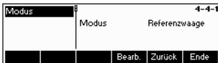
Drücken Sie die Taste «**Bearb.**», um den Modus des Eingangssignals der Analogoption zu ändern.
