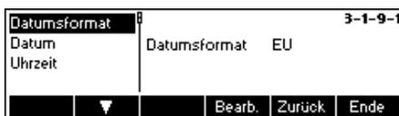
Drücken Sie die Taste **«Bearb.»**, um das Format entweder in US oder EU zu ändern. Wählen Sie Datum, um das Datum zu ändern und Uhrzeit, um die Uhrzeit zu ändern. Bestätigen Sie mit **«OK»**.
