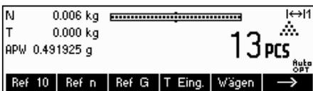
Smart Count ist nun zur Stückzählung bereit unter Einbeziehung des optimierten mittleren Stückgewichts.
