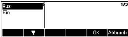
Aktivieren Sie das automatische Löschen des mittleren Stückgewichts mit der Auswahl „Ein“ oder deaktivieren Sie es mit der Auswahl „Aus“.
