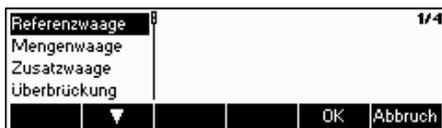
Wählen Sie **Referenzwaage, Mengenwaage, Zusatzwaage oder Überbrückung** und drücken Sie «**OK**», um den gewünschten Modus auszuwählen.
