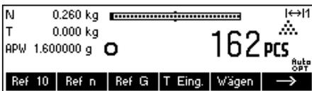
**Referenz** Die Zweitwaage wird ausschliesslich zur Referenzgewichtsbestimmung eingesetzt. Das mittlere Stückgewicht wird, ungeachtet der aktiven Waage, aus dem auf die Zweitwaage aufgebrachten Gewicht errechnet. Dies ist der Fall, wenn die Zweitwaage eine feinere Auflösung als die Smart-Count-Waage besitzt, um so ein genaueres Stückgewicht zu erhalten.
