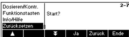
Drücken Sie «**Ja**», um die Applikationseinstellungen zurückzusetzen. Wird „START?“ angezeigt, bestätigen Sie mit der Taste «**Ja**». Die Applikationseinstellungen sind nun auf die ursprünglichen Werkseinstellungen zurückgesetzt.
