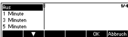
Die Waage schaltet nach Ablauf der ausgewählten Zeit automatisch ab.
