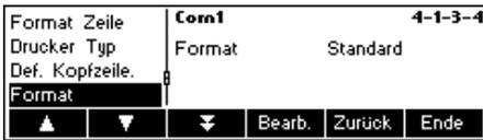
Menü Format: Der Ausdruck kann entsprechend den Spezifikationen des Bedieners geändert werden. Wählen Sie dazu eher „Kundenspezifisch“ anstelle von „Standard“ aus. Wurde „Kundenspezifisch“ ausgewählt, können Sie über die Taste «▼» in das nun aktivierte Linienmenü gelangen, um den Zeilenausdruck an Ihre spezifischen Anforderungen anzupassen.
