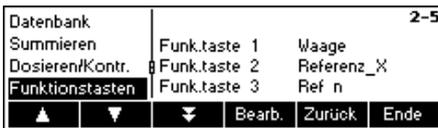
Drücken Sie «**Bearb.**», um in die Menüeinstellungen der Funktionstasten-Konfiguration zu gelangen.
