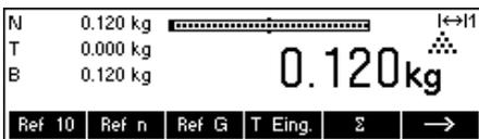
Bringen Sie den vollen Wägebehälter auf die Waagschale auf und tariieren Sie die Waage mit der Taste «→T←».
