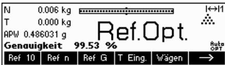
Nachdem die spezifizierte Stückzahl auf die Waage aufgebracht wurde, wird das mittlere Stückgewicht optimiert (Kapitel 4.3) und, da die Genauigkeitsanzeige aktiv ist, für ca. 4 Sekunden die prozentuale Genauigkeit angezeigt.
