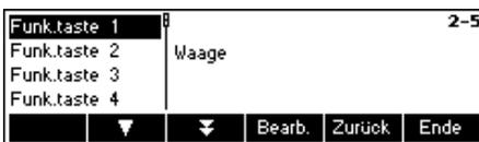
Wählen Sie die gewünschte Funktionstaste aus, die definiert werden soll und drücken Sie «**Bearb.**», um ihre Funktion festzulegen. Es ist möglich, bis zu 30 Funktionstasten zu definieren.
