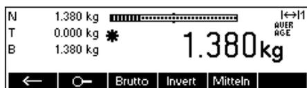
Nach 10 Sekunden zeigt Smart Count das Durchschnittsgewicht der Last an. Beachten Sie, dass die Anzeige „AVERAGE“ oben rechts in der Anzeige sichtbar ist, wenn Sie sich im Modus Mitteln befinden.
