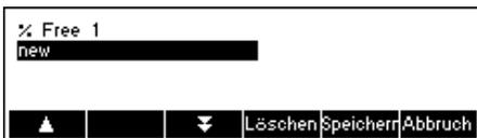
Sie können den soeben definierten Faktor und die soeben definierte Einheit durch Drücken der Funktionstaste **«Speichern»** sichern. Während Sie sich in diesem Bildschirm befinden, können Sie bereits gespeicherte Faktor-/Einheit-Definitionen löschen oder die aktuelle Definition speichern.
