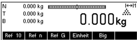
Die Waage führt einen Anzeigetest (Kapitel 1.4) durch. Sobald die Gewichtsanzeige erscheint, ist die Waage betriebsbereit und automatisch nullgestellt.
