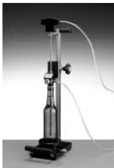
Dispositif de perçage pour bouteilles et boîtes (Haffmans InPack 2000)
