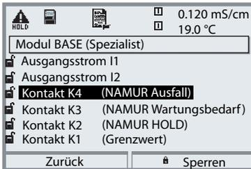
**NAMUR-Signale:** Lieferzustand der Kontaktbelegung
