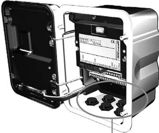
Kabeldurchführung muß dicht schließen (Schutz gegen eindringende Feuchtigkeit).
