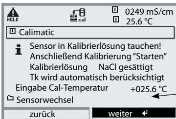
Die Temperatur der Kalibrierlösung muß manuell im Kalibriermenü eingegeben werden. Wenn "Cal-Temperatur automatisch" parametriert ist, erscheint "gemessene Cal-Temperatur" im Menü. Wenn "Cal-Temperatur manuell" parametriert ist, erscheint "Eingabe Cal-Temperatur" im Menü.
