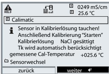
Bei der automatischen Erfassung der Cal-Temperatur mißt M 700 die Temperatur der Kalibrierlösung mit einem Temperaturfühler (Pt 100/Pt 1000 / NTC 30 k $\Omega$ ). Wenn mit automatischer Temperaturkompensation bei der Kalibrierung gearbeitet werden soll, muß ein Temperaturfühler in der Kalibrierlösung sein, der mit dem Temperatureingang
