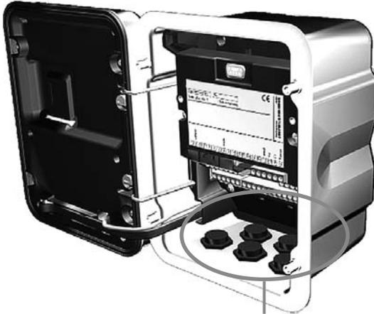
Kabeldurchführung muß dicht schließen (Schutz gegen eindringende Feuchtigkeit).
