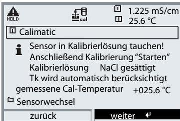
Bei der automatischen Erfassung der Cal-Temperatur mißt das Meßmodul die Temperatur der Kalibrierlösung mit einem Temperaturfühler (Pt 100/Pt 1000 / NTC 30 k $\Omega$  / NTC 100 k $\Omega$ ). Wenn mit automatischer Temperaturkompensation bei der Kalibrierung gearbeitet werden soll, muß ein Temperaturfühler in der Kalibrierlösung sein, der mit dem
