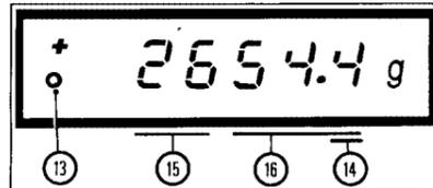
PE3000/PE6000: lorsqu'on place un objet sur le plateau, la dernière décimale (14) s'éteint. Le poids affiché ne doit être lu que lorsque la dernière décimale (14) réapparaît et que le témoin (13) du détecteur de stabilisation est éteint.
