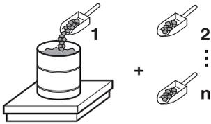
In quest'applicazione potete dosare per addizione più componenti l'uno dopo l'altro in un contenitore. Ciascuna ricetta e ciascun componente possono essere dotati di una identificazione.
