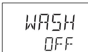
Después de 2 segundos , la pantalla muestra el estado del relé Wash (lavado) y se enciende LED "W". Si el relé Wash (lavado) está apagado , la pantalla muestra " WASH OFF " . Si el relé Wash (lavado) está encendido , aparece el tiempo de intervalo de lavado y la duración del lavado.
