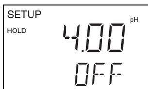
Si seleccionó control Límite: La pantalla muestra el valor medido actual y "OFF" o "ON" dependiendo del estado del relé del relé actualmente seleccionado.
