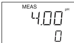
Si seleccionó control de longitud de Pulso : La pantalla muestra el valor medido actual (valor superior) y la duración actual. ( valor inferior).
