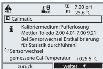
Bei der automatischen Erfassung der Cal-Temperatur mißt M700 die Temperatur der Pufferlösung mit einem Temperaturfühler (Pt 100/Pt 1000/ NTC 30 k $\Omega$ /NTC 8,55 k $\Omega$ ). Wenn mit automatischer Temperaturkompensation bei der Kalibrierung gearbeitet werden soll, muß ein Temperaturfühler in der Pufferlösung sein, der mit dem Temperatur-
