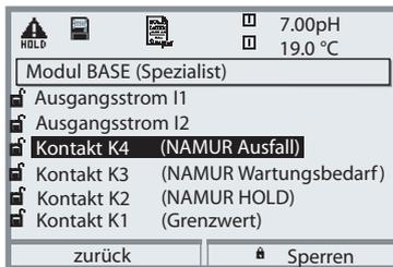
**NAMUR-Signale;** Lieferzustand der Kontaktbelegung
