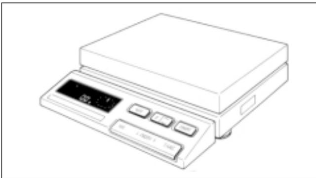
Avec les balances METTLER TOLEDO de la série SM, les principaux ordres peuvent également être donnés sur le terminal de balance. Après la sélection d'une l'application, l'entrée et la sauvegarde des valeurs, on peut par conséquent retirer le PharmaPac-M, jusqu'à ce qu'une modification du réglage soit souhaitée. Le terminal SM ne permet pas de modifier des valeurs entrées.
