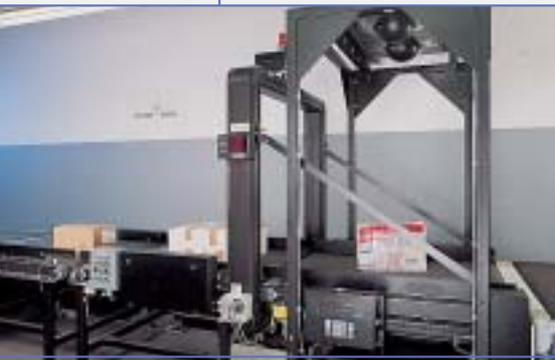
**< Komplettlösung zur Datenerfassung mit dem CS5000 Messrahmen**
