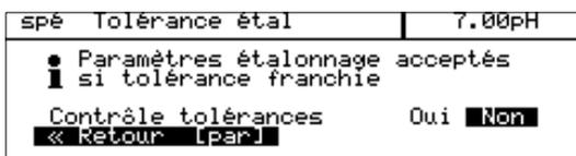
Lorsque le contrôle de la bande de tolérance est désactivé, tous les étalonnages sont directement enregistrés. La trace d'étalonnage ne mentionne pas de bande de tolérance. L'enregistreur de bande de tolérance présente les données d'étalonnage sans limites de tolérance.
