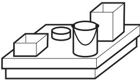
Con la función tara aditiva puede tarar en pesadas vinculadas recipientes adicionales con peso de tara conocido, p. ej. cuando en una plataforma de carga se llenan distintos recipientes pesados
