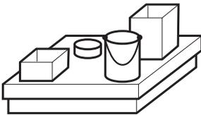
Mit der additiven Tara-Funktion können Sie bei zusammenhängenden Wägungen zusätzliche Behälter mit bekanntem Taragewicht wegtarieren, z. B. wenn auf einer Palette unterschiedlich schwere Behälter befüllt werden.
