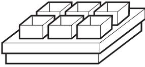
Die multiplikative Tara-Funktion eignet sich besonders, wenn Paletten mit gleichen Behältern befüllt werden.
