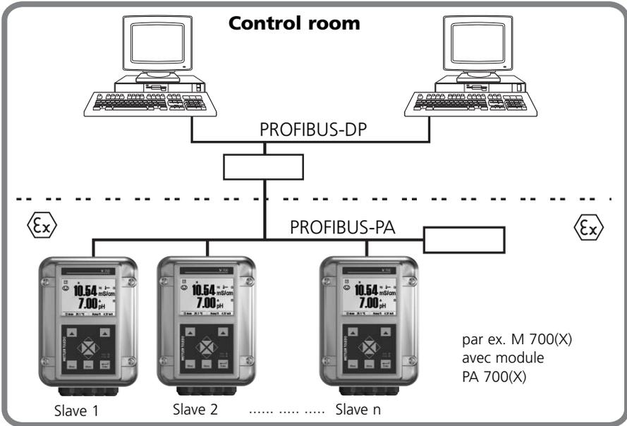
Le raccordement électrique du module à la PROFIBUS PA se fait conformément à la PROFIBUS Guideline, Order No. 2.092 ([www.profibus.com](http://www.profibus.com)).
